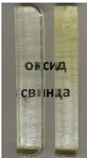
Рис. 2. Образцы свинцовогерманатных стекол. Надпись “оксид свинца” просвечивает через толщину образца.
