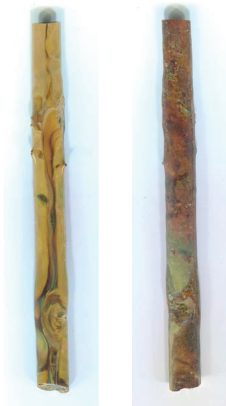
Рис. 1. Внешний вид образцов свинцовогерманатного стекла состава 30PbO · 70GeO 2 , мол. %.
