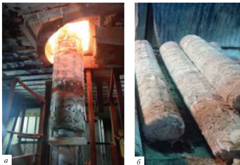
Рис. 2. Фотография этапа выработки стекла (а) и слитков кварцевого стекла, полученных в результате плавления кварцевого песка (б).
