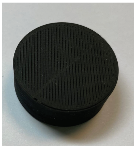
Рис. 5. Фотография цилиндра, полученного методом FDM печати.
