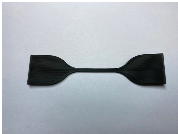
Рис. 4. Фотография лопатки, полученной методом FDM печати.
