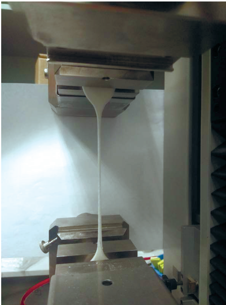
Рис. 3. Проведение испытаний лопаток на разрыв.
