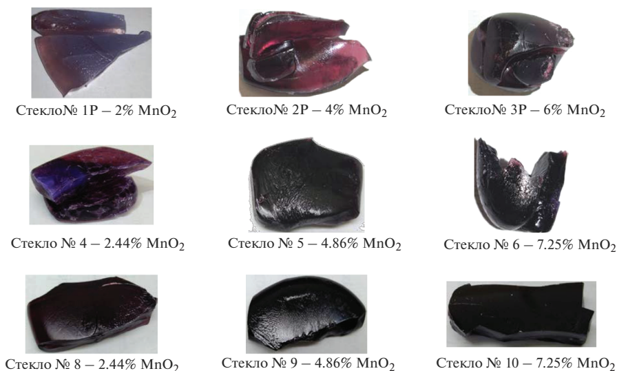
Рис. 2. Фотографии марганецсодержащих стекол, отоженных при 450°C.
