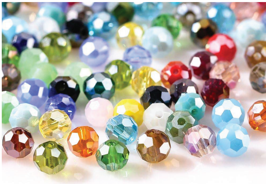
Рис. 16. Свободное формование под действием поверхностного натяжения.
