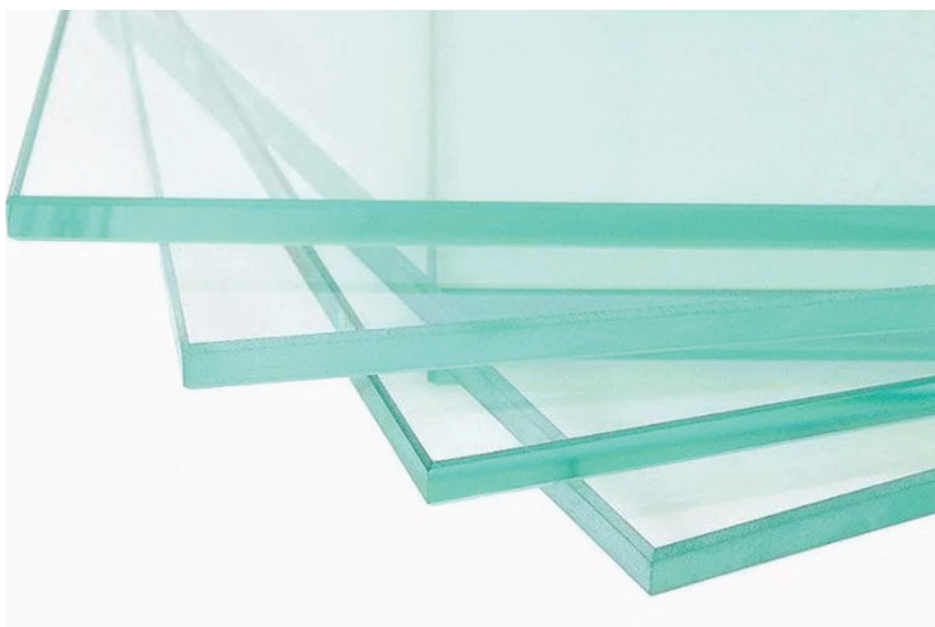
Рис. 12. Изделие из стекла, выполненное методом вытягивания.
