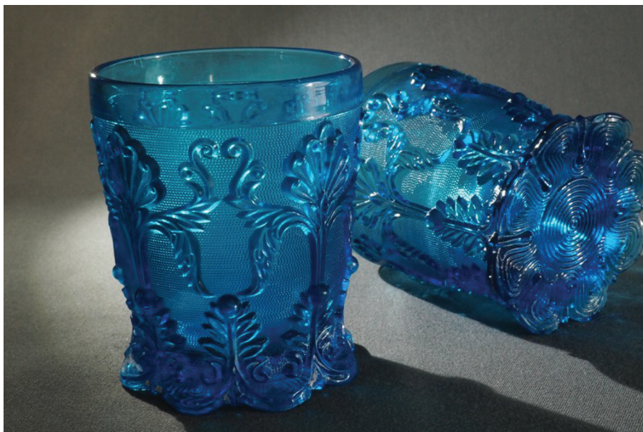
Рис. 7. Изделие из стекла, выполненное методом прессования.
