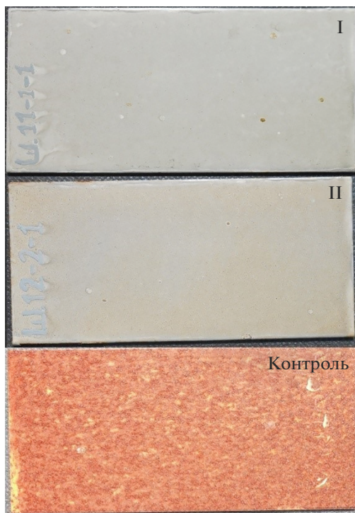
Рис. 4. Внешний вид покрытий I, II и контрольного образца после экспозиции в течение 6 мес. на открытом испытательном стенде в г. Ханой.
