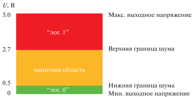
Рис. 11. Уровни логических нуля и единицы при размахе напряжения питания 5 В, обеспечивающие высокую помехоустойчивость обрабатываемых сигналов. Диапазоны сигналов V_O (выход источника сигнала) для логических нуля и единицы уже, чем аналогичные диапазоны V_I (вход приемника сигнала), что также компенсирует возможные пульсации напряжения при передаче в линиях связи между логическими элементами, источником и приемником.
