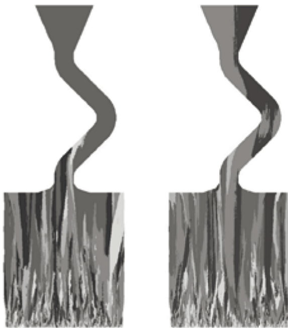
Рис. 6. Типичный вид продольного сечения кристаллоотборника с монокристаллической (а) и не монокристаллической (б) структурой в выходном сечении.
