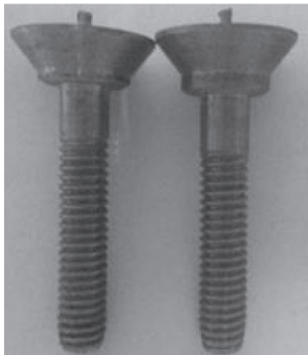
Рис. 6. Изготовленные из стали марки 35ХМ футеровочные болты.
