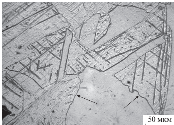
Рис. 5. Рекристаллизация путем миграции границ в малом цилиндре, нагруженном плоской ударной волной. Нагрев при 350°C, 1 мин.
