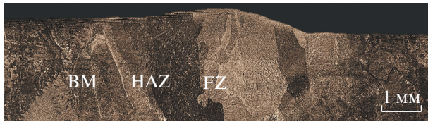
Рис. 3. Оптическое изображение микроstructures поперечного сечения сварного шва 3D-напечатанного сплава Ti-6Al-4V.
