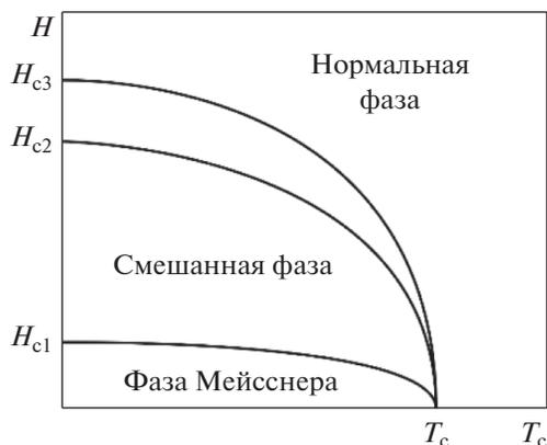
**Рис. 2.** Фазовая диаграмма сверхпроводника второго рода. Область между  $H_{c2}$  и  $H_{c3}$  является областью поверхностной сверхпроводимости.
