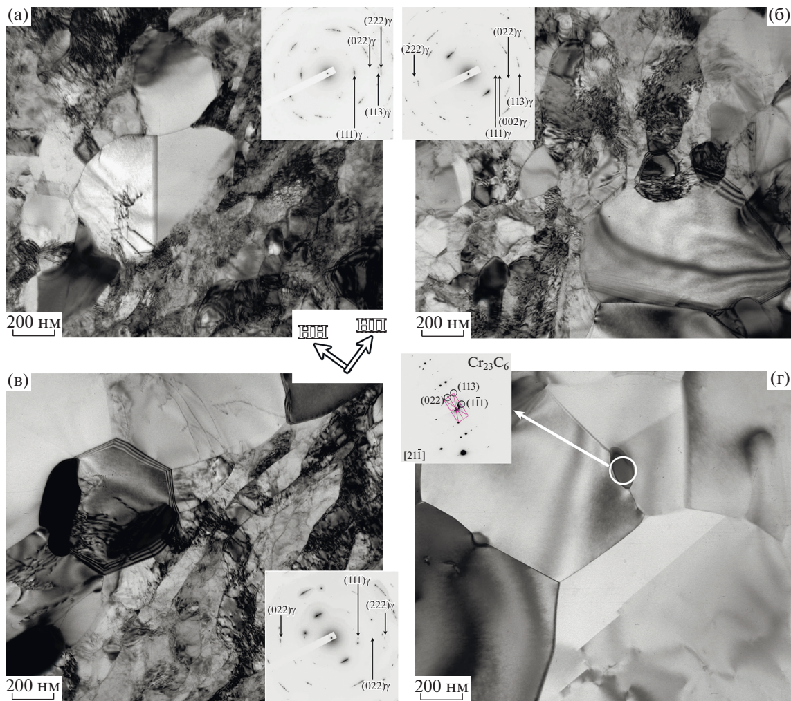
Рис. 3. Тонкая структура стали 304L после прокатки при 200^{\circ}\text{C} до истинной деформации e = 3 и последующего отжига при температуре 700^{\circ}\text{C} в течение 30 (а), 60 (б), 120 (в) и 480 мин (г).
