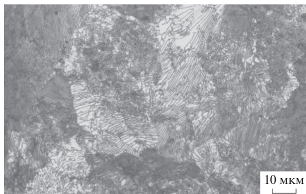
Рис. 5. Микроструктура пластинчатого перлита (образец № 2), после растяжения на 1.5%.
