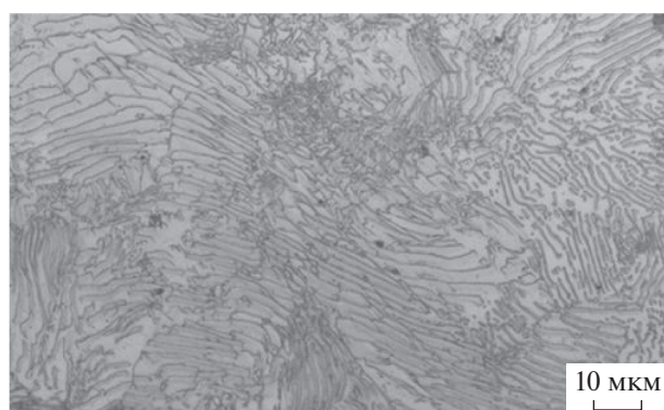
Рис. 3. Микроструктура грубопластинчатого перлита, образец № 3.
