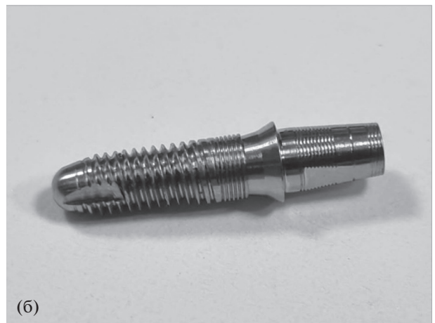
Рис. 5. Внешний вид имплантата, полученного из прутка сплава Zr–2.5% Nb после РК: а – супраструктура (абатмент); б – система имплантат-абатмент в сборе.
