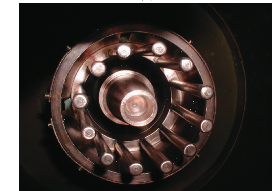
Рис. 16. Схема (а) и общий вид МПК (б) компактной геометрии. 1, 2 — цилиндрические части катода и анода; 3, 4 — конические части анода и катода; 5, 6 — цилиндрическая и профилированные части канала; 7 — торцевой фланец; 8 — продольный изолятор.
