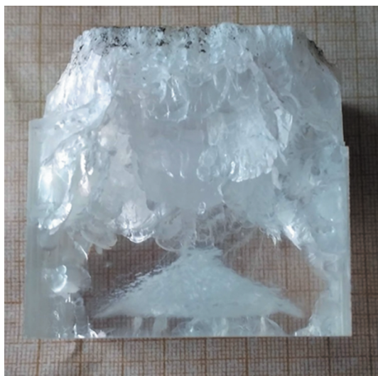
Рис. 10. (в цвете онлайн) Разрушение образцов из оргстекла при объемном энерговыведении.
