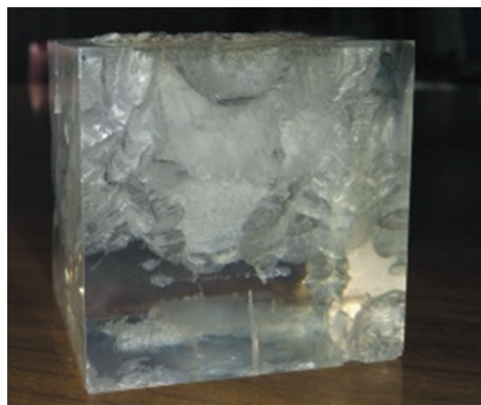
Рис. 9. (в цвете онлайн) Разрушение образцов из полистирола при объемном энерговыведении.
