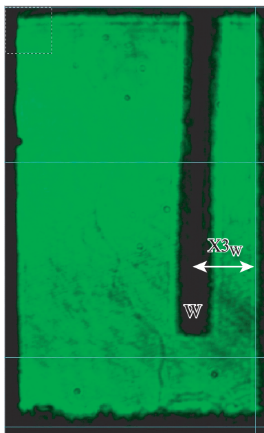
Рис. 2. Теневое лазерное изображение фляера с мишенью из вольфрама, полученное до выстрела в оптическом канале № 3. В левом верхнем углу для масштаба показан квадрат со стороной 1 мм. W – тень мишени из вольфрама.
