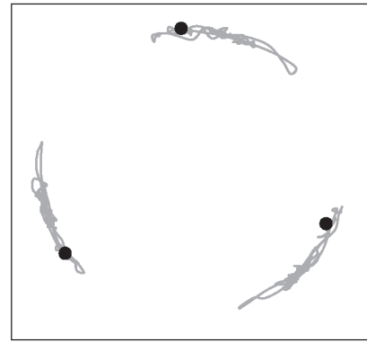
Рис. 3. Иллюстрация траекторий для трех частиц в радиальной плоскости цилиндрической ловушки за время t = 40/v при коэффициенте трения v = 2 \text{ с}^{-1} и температуре T = 0.027 \text{ эВ} .
