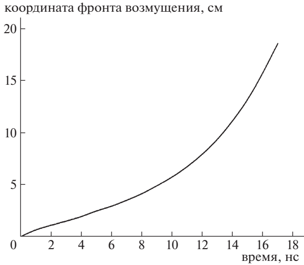
Рис. 9. Распространение возмущения по первичному каналу длиной 19 см при подаче на анод дополнительного импульса напряжения амплитудой 50 кВ с постоянной времени нарастания 1 нс и временем затухания 2 нс.
