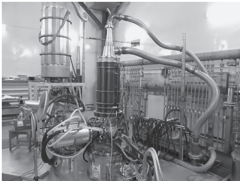
Рис. 2. Гиротрон для ИТЭР с системой охлаждения (справа) и основной нагрузкой (слева).
