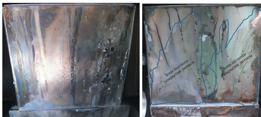
Рис. 5. Вид поверхности литиевого лимитера LLL токамака EAST. Скорость потока лития V_{Li} = 1 см/с (эксперименты 2016 г.): гладкая поверхность (а); капиллярные бороздки перпендикулярные направлению потока (б) [12].
