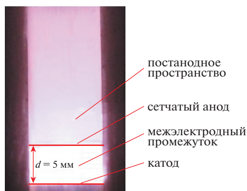
Рис. 2. Фотография тлеющего разряда с сетчатым анодом в гелии при p = 10 Торр, V = 400 В, I = 0.33 А.
