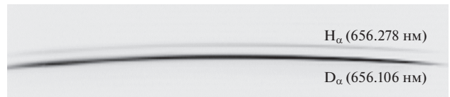
Рис. 8. Калибровочный спектр эталонной дейтериевой лампы ДДС-30, полученный спектрометром с пространственным разрешением.
