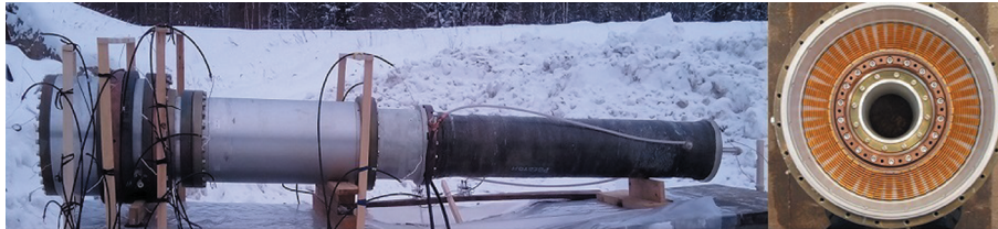
Рис. 2. Внешний вид экспериментального устройства (размеры: максимальный диаметр \varnothing 0.63 м; длина – 3.5 м) и ФЭРТ в виде “змейки”.
