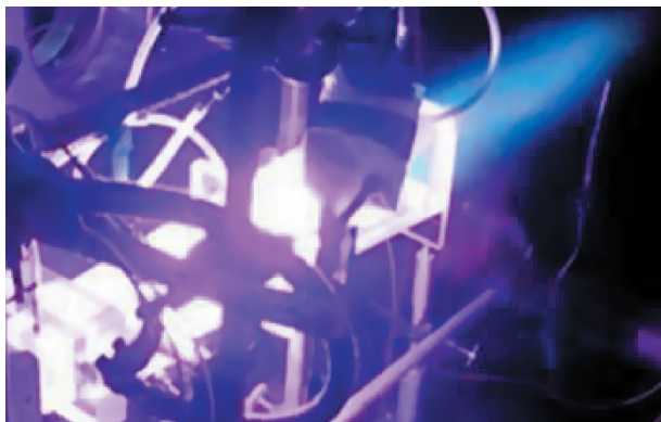
Рис. 9. Фотография плазменно-стимулированного горения пропан-воздушного топлива в расширяющемся аэродинамическом канале длиной L = 50 см. Время экспозиции кадра t_{\text{exp}} = 16 мс из полного времени пуска 2 с.
