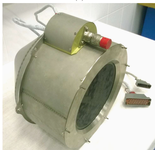
Рис. 5. Эскизная схема ионного двигателя (а) и внешний вид ИД-200 КР (б)
