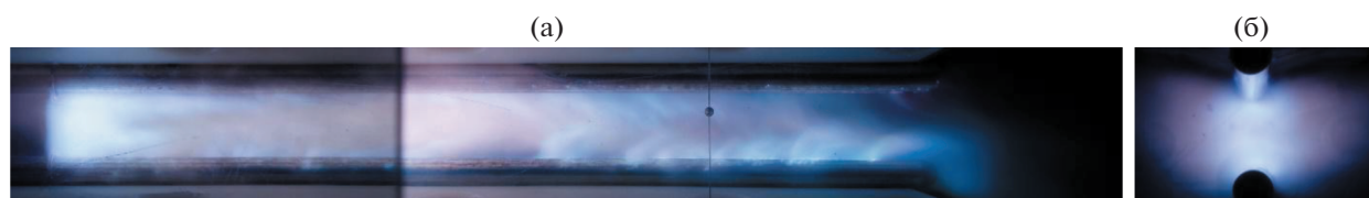
Рис. 5. Внешний вид сильноточного разряда. а) Вид сбоку; б) вид спереди. Катод находится внизу. Газ N_2 , P = 50 Торр, h = 30 мм, U_0 = 5 кВ, I_{\max} = 25 кА.
