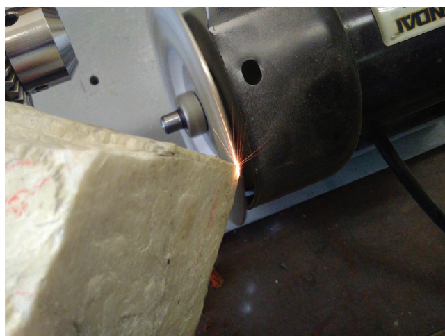
Рис. 2. ФЛ образца олигоклаза при разрушении образца.
