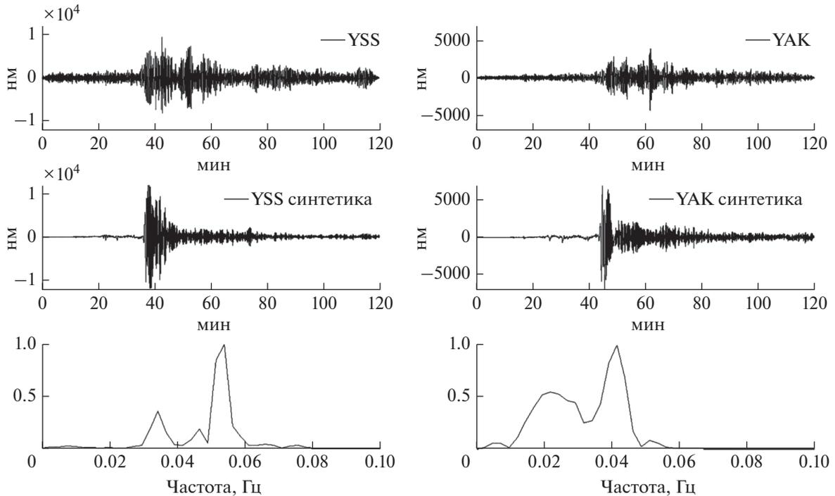
**Рис. 3.** Пример синтетической сейсмограммы (вертикальная компонента) на станциях YSS, YAK и спектры когерентности. Наблюдаемая сейсмограмма предварительно отфильтрована в полосе 0.01–1 Гц.
