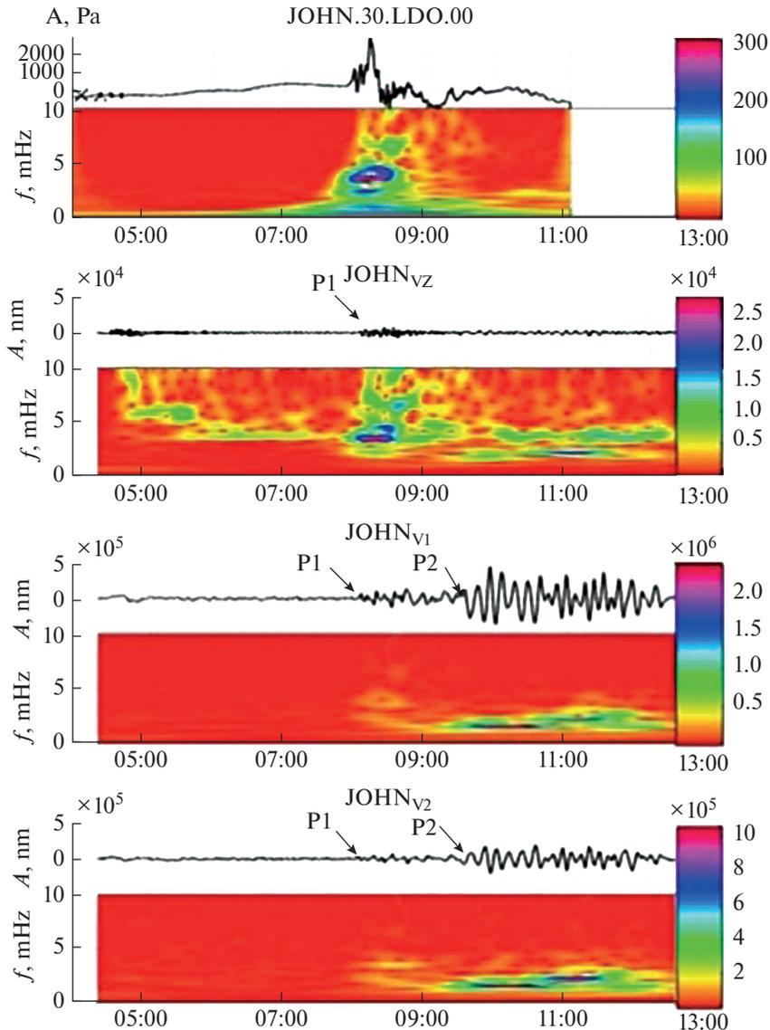
**Рис. 7.** Последовательно сверху вниз – барограмма и соответствующая ей спектрально-временная диаграмма, а также сейсмограммы (Z, E-W, N-S компоненты) и их спектрально-временные диаграммы на сейсмической станции Джонстон (JOHN). На оси абсцисс – время UTC 15.01.2022 г.
