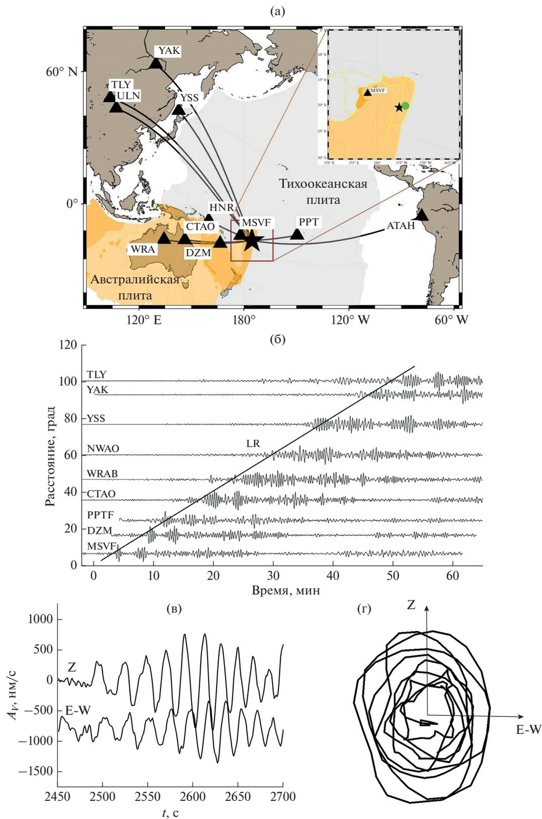
**Рис. 2.** (а) – Расположение станций (черные треугольники) относительно вулкана (звездочка); (б) – сейсмограммы с записями поверхностных волн Рэля, использованные для определения магнитуды; (в) – фрагмент волн Рэля на станции СТАО на вертикальном и горизонтальном канале; (г) – траектория движения частиц в вертикальной плоскости, проходящей через станцию и эпицентр. Зеленая точка на врезке в (а) - землетрясение 03.05.2006.
