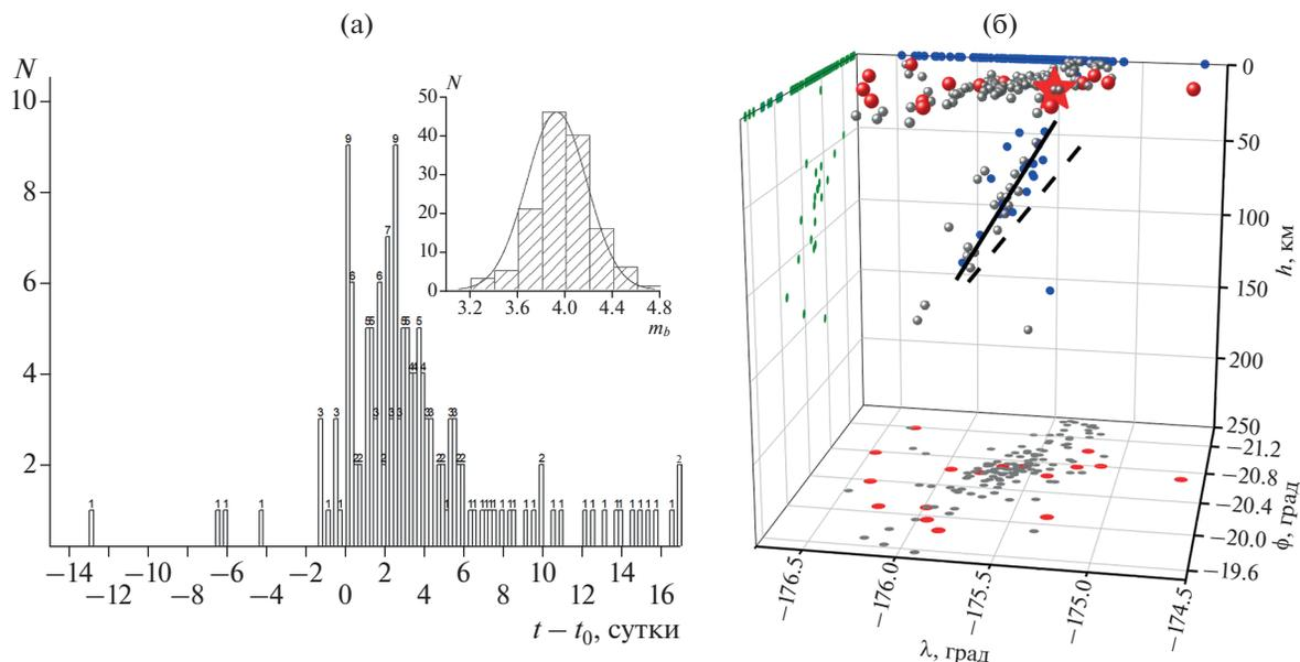
**Рис. 1.** (а) – Распределение числа сейсмических событий в сутки за 15 сут до и 15 сут после извержения вулкана; на врезке – распределение землетрясений по магнитуде; (б) – распределение землетрясений в пространстве: красная звездочка – извержение вулкана; красные шарики – землетрясения до извержения; серые шарики – землетрясения после извержения; синие, зеленые кружки – проекции землетрясений на две вертикальные, а серые и красные кружки – проекции на горизонтальную плоскость.
