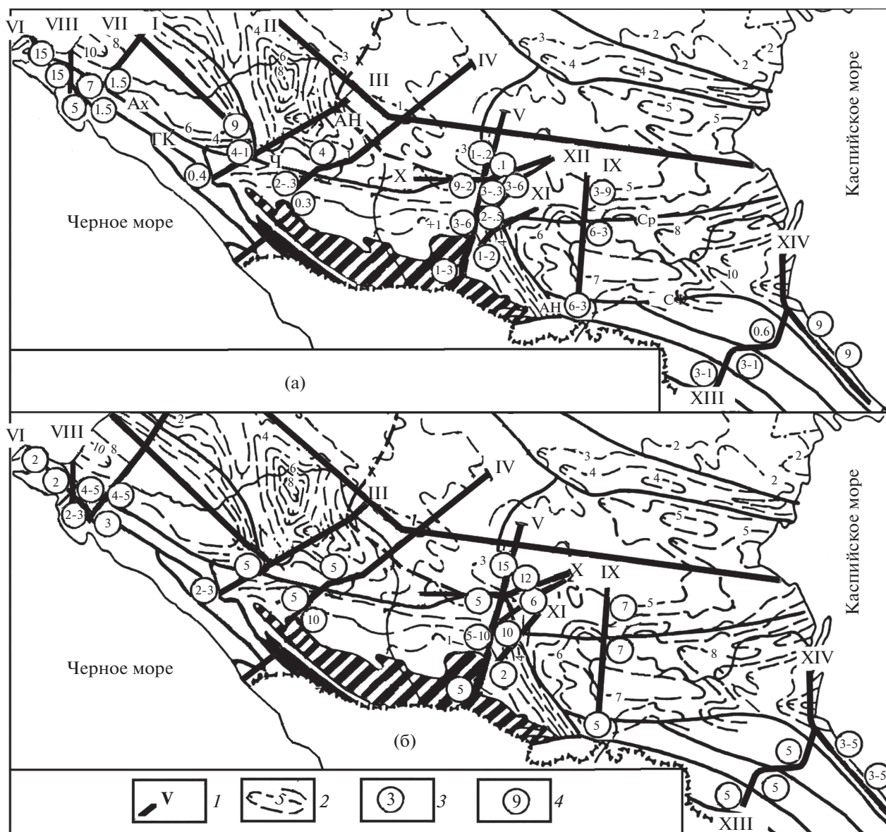
Рис. 11. Распределение связанных долей флюида f_p (%) в Северо-Кавказском регионе: 1 – профили МТЗ, 2 – глубина до фундамента; 3 – доля флюида (а); 4 – глубина до зон повышенного содержания f_p (б).
