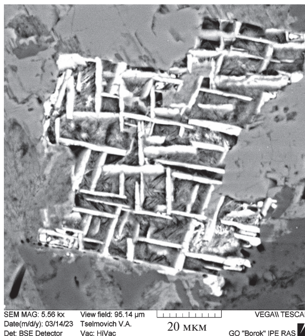
Рис. 6. Микрофотография (в обратно рассеянных электронах) образца № Е сила после травления поверхности аншлифа в соляной кислоте.
