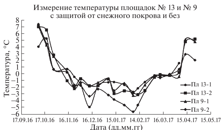
Рис. 5. Изменение температуры грунтов на пл. № 9 (склон) и № 13 (речная терраса) со снежным покровом (9–1 и 13–1) и без него (9–2 и 13–2).
