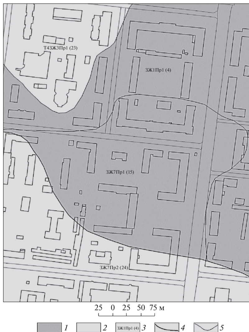
Рис. 4. Фрагмент карты-схемы оценки риска участка Покровское-Стрешнево. Категории риска: 1 — низкая; 2 — средняя. 3 — код природно-техногенных условий. Границы между: 4 — ИГМ, 5 — типами техногенной нагрузки.
