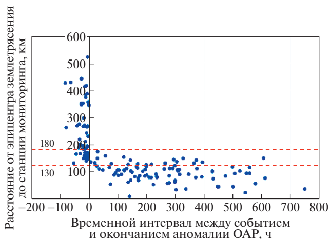
Рис. 5. Зависимость расстояния между станцией мониторинга и событием от времени между окончанием аномалии радона и землетрясением для M/IgR \geq 2 .
