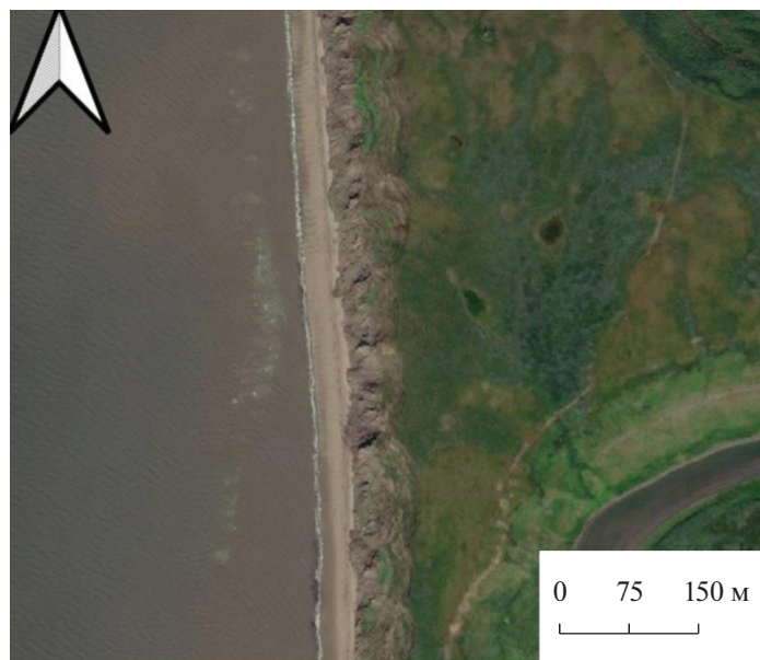
Рис. 5. Типичное изображение абразионных берегов с развитием оползневых процессов в криолитозоне на материалах космической съемки.
