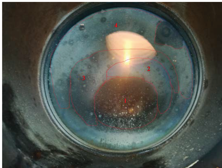
Рис. 6. Фотография налёта на иллюминаторе и области сбора проб для рентгеновского дифракционного исследования.
