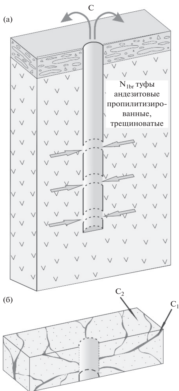
Рис. 4. Скважина М-1. Схема формирования ионного состава воды. (а) – строение скважины и ее водоносной системы: пунктирные линии – границы участков перфорации ствола; горизонтальные стрелки – направление поступления смешанной воды в ствол скважины; С – концентрация ионов в воде из скважины. (б) – фрагмент водоносной системы в среде с двойной пористостью: C_1 – концентрация индикаторного показателя в воде из “трещин”, C_2 – из “блоков”.
