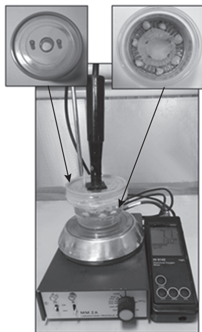
Рис. 2. Лабораторная установка для измерения скорости потребления кислорода моллюсками.
