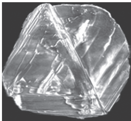
Рис. 3. Общий вид уплощенного алмаза-включения в образце “Матрешка”. Рентгеновское микротомографическое 3D-изображение (Коногорова и др., 2020).
