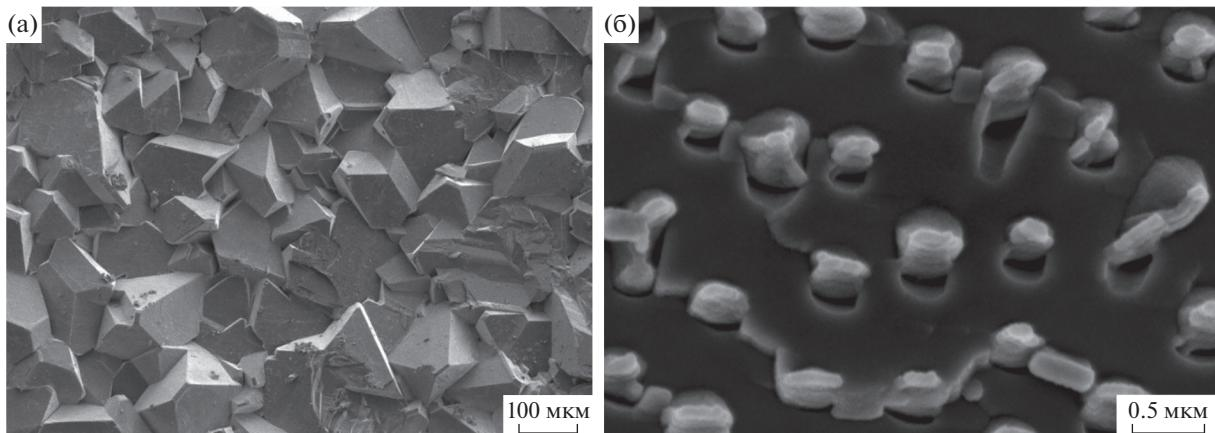
**Фиг. 2.** Синтезированные алмазы, образовавшиеся в графитовом слое – источнике углерода (эксперимент 4-19-19): (а) – общий вид алмазного агрегата; (б) – захват включений растущей гранью кристалла алмаза. СЭМ-изображения сделаны во вторичных электронах.
