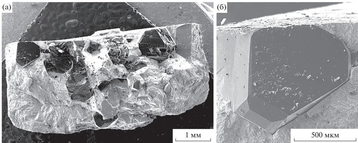
**Фиг. 4.** Образец из эксперимента 4-25-21: (а) – общий вид образца; (б) – отдельный нарощий на затравку кристалл алмаза. СЭМ-изображения сделаны во вторичных электронах.
