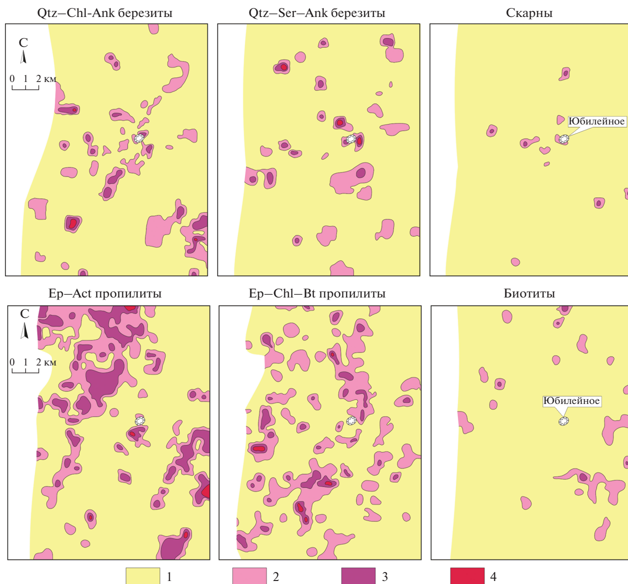
Фиг. 6. Плутоногенные минеральные парагенезисы филлизитов–березитов, скарнов, эпидот-хлоритовых и эпидот-актинолитовых пропилитов и биотитов в гидротермально измененных породах района Юбилейного месторождения. 1–4 – интенсивность проявления гидротермального изменения пород: 1 – изменение отсутствует, 2 – слабая–умеренная (5–10%), 3 – сильная (10–25%), 4 – интенсивная (> 25% новообразований).
