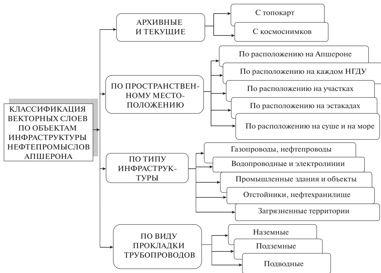
Рис. 5. Классификация векторных слоев объектов инфраструктуры нефтепромыслов на Апшеронском полуострове.
