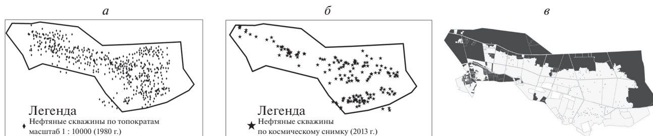
Рис. 4. Сравнительный анализ инфраструктуры нефтепромысла им. З. Тагиева по нефтяным скважинам по состоянию на 1980 и 2013 гг. а – распределение скважин на нефтепромысле им. З. Тагиева в 1980 г., б – распределение скважин на нефтепромысле им. З. Тагиева в 2013 г., в – темным цветом указана территория нефтепромысла, отведенная под жилые постройки.
