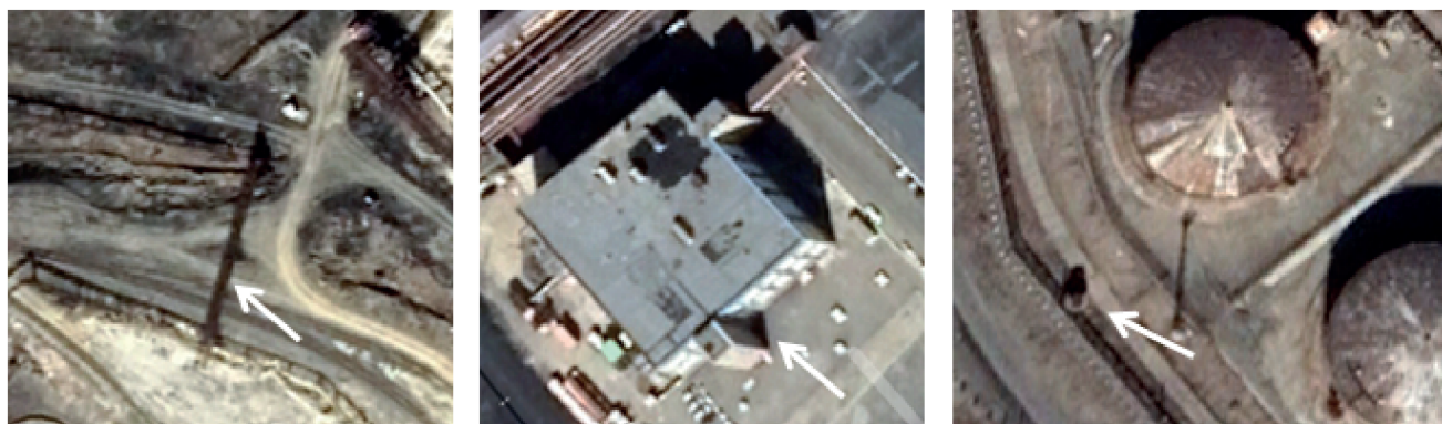
Рис. 4. Фрагменты снимков Google Earth, содержащие опорные объекты: трубопровод (слева), внутренний угол здания (в центре) и сооружение у ограждения резервуаров (справа).
