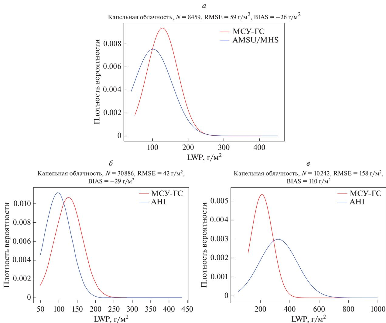
**Рис. 3.** Функции плотности вероятности оценок LWP: *a* – MSU-FC и AMSU/MHS (кап. облачность) *б* – MSU-FC и ANI (кап. облачность) *в* – MSU-FC и ANI (крист. облачность).
