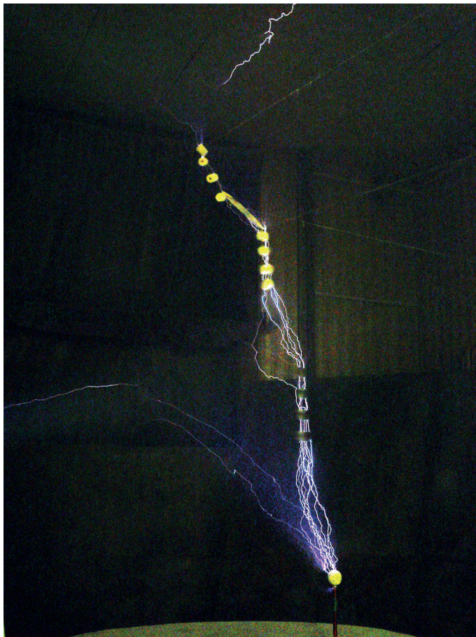
Рис. 2. Формирование канальных разрядов между системой отрицательно заряженных искусственных грозовых ячеек и землей с участием нескольких групп модельных гидрометеоров.
