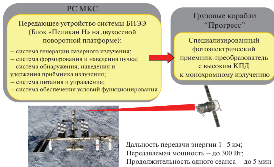
Рис. 1. Схема проведения космического эксперимента «Пеликан».
