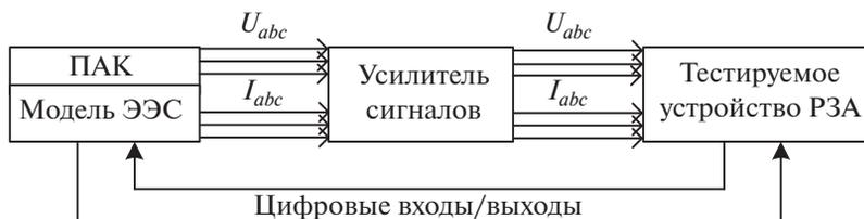
Рис. 1. Блок-схема организации тестирования в замкнутом цикле устройств РЗА.
