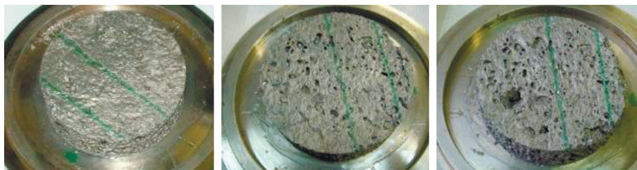
Рис. 11. Образцы винилпласта после воздействия ударной волны.
