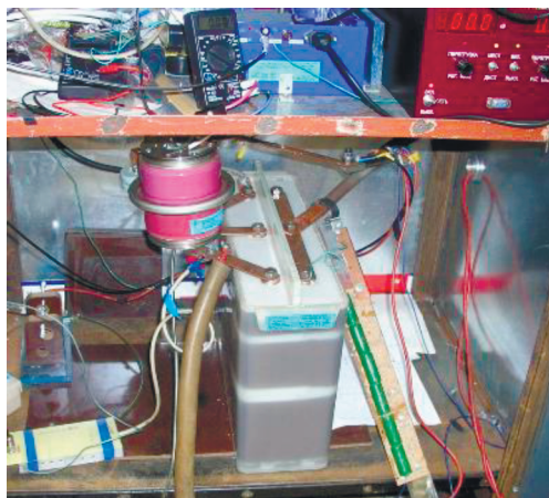
Рис. 4. Установка для взрыва проволоочки импульсом электрического тока: 1 – разрядник РГУ-1, 2 – высоковольтный конденсатор 54 мкФ 15 кВ, 3 – высоковольтный источник питания ИВН-3.
