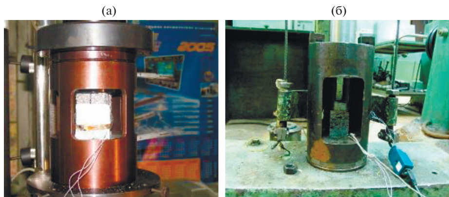
Рис. 1. Общий вид приспособления для испытаний образцов на статическое (а) и динамическое (б) сжатия.
